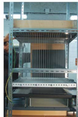
Fig. 9 : Prototypes expérimentaux en modélisation analogique. En haut : boîte réversible avec mesures de force . En bas : à gauche, boîte de taille plus grande financée par TOTAL dans le cadre d'un projet avec Manuel Pubellier, à droite, semeuse mise au point pour réaliser des couches homogènes de sable.
